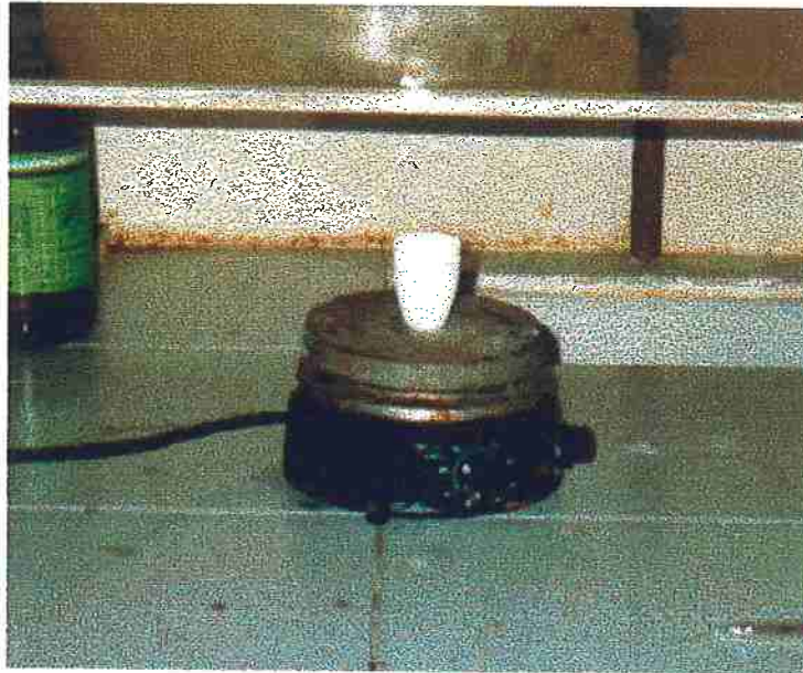
Figura 20: Chapa aquecedora e cadinho.
